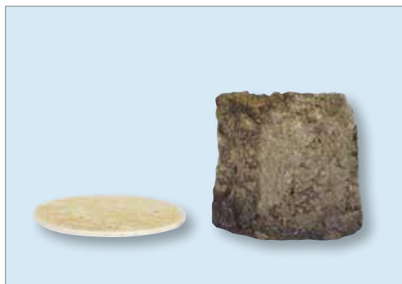
INTERDENS typ 36 przed i po ekspansji ogniowej
