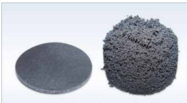
2 mm grubość Flexilodice prze i po ekspansji ogniowej
